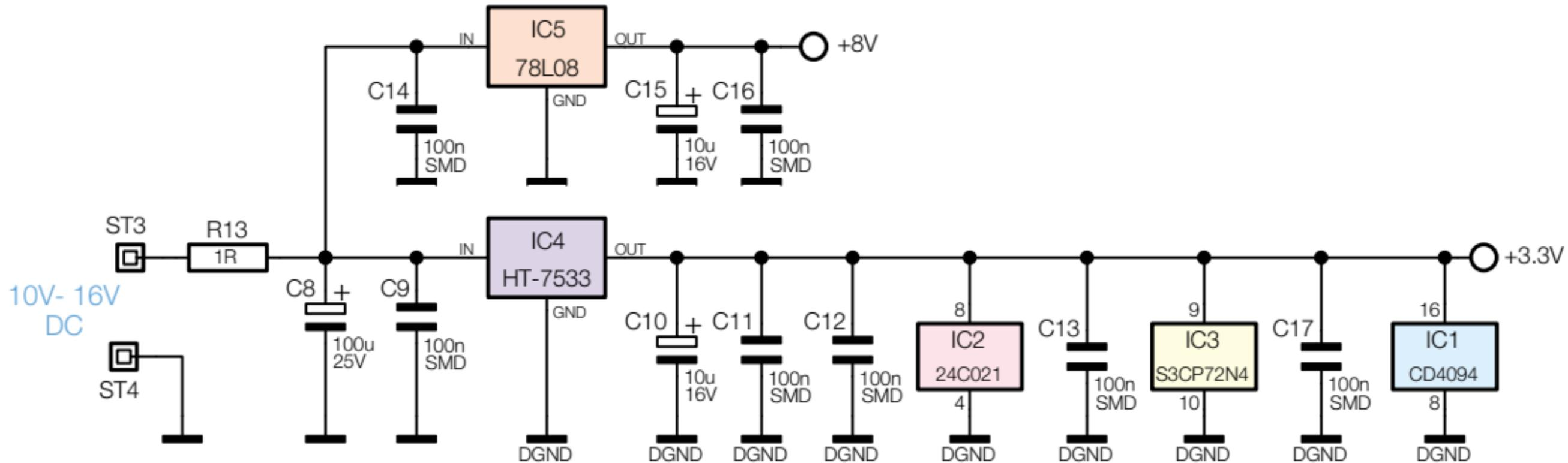
Bild 8: Schaltbild der Spannungsversorgung
