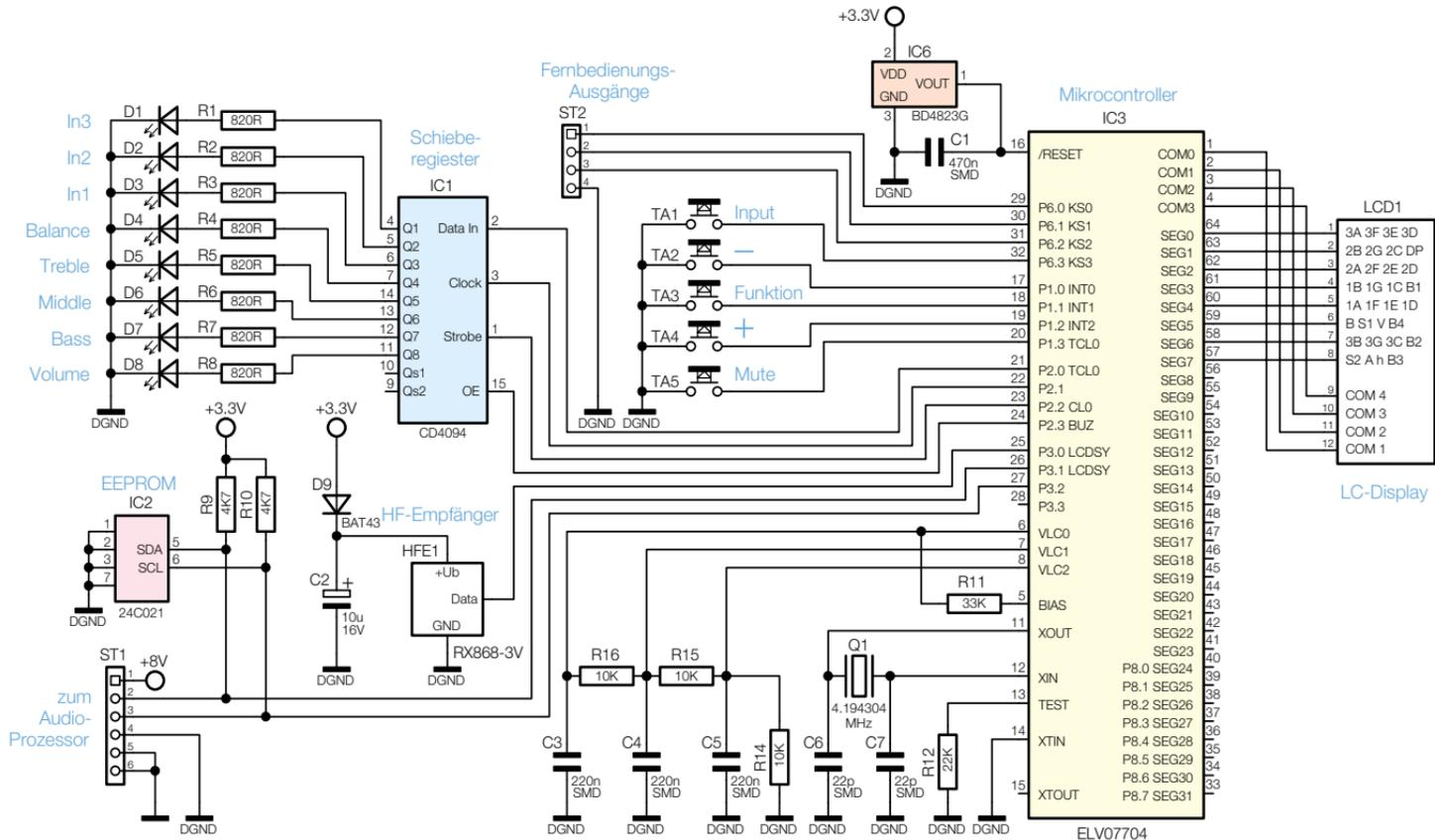
Bild 5: Schaltbild der Bedieneinheit mit dem Mikrocontroller
