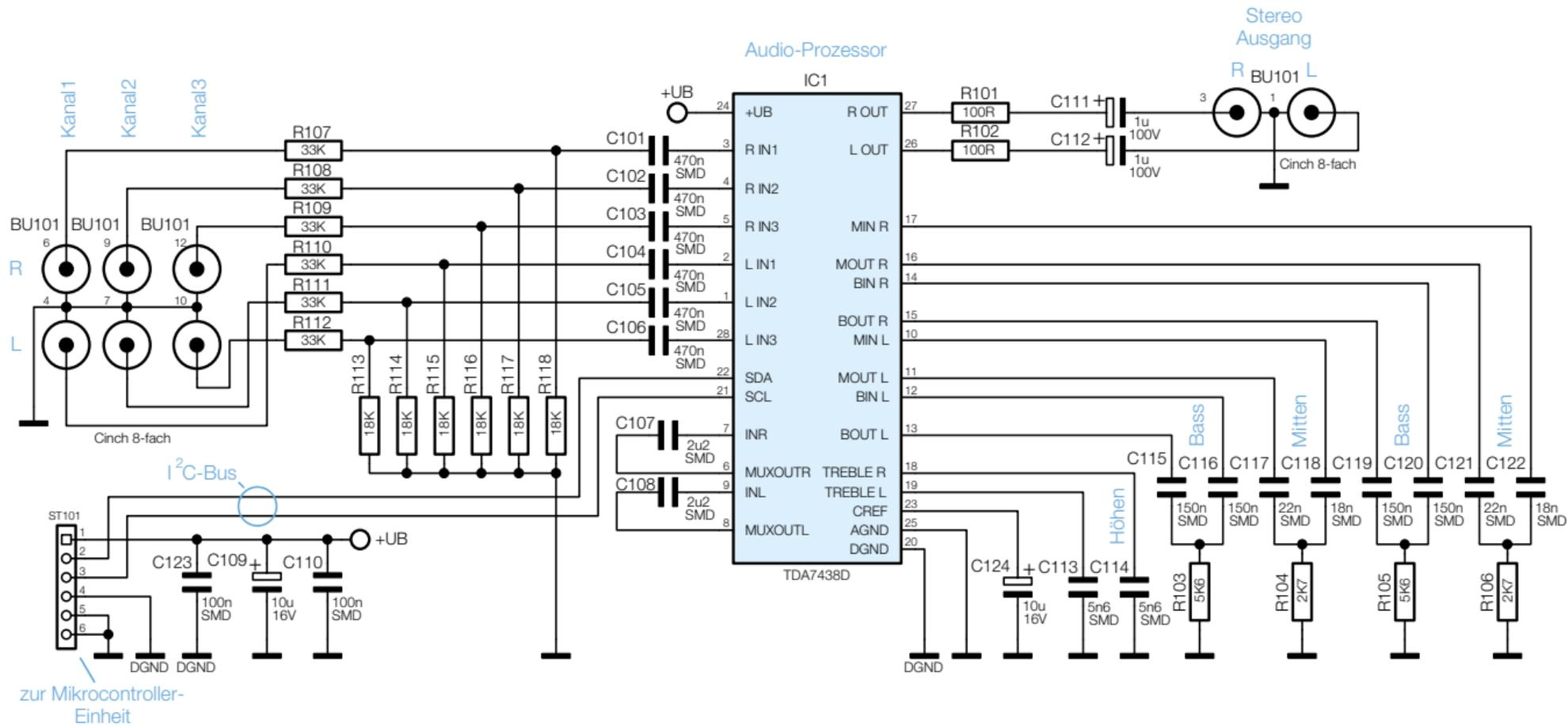
Bild 6: Schaltbild des digitalen Audio-Prozessors mit Audio-Ein- und -Ausgängen
