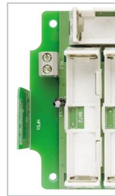
Bild 3: Seitlich angelötetes HF-Sendemodul
