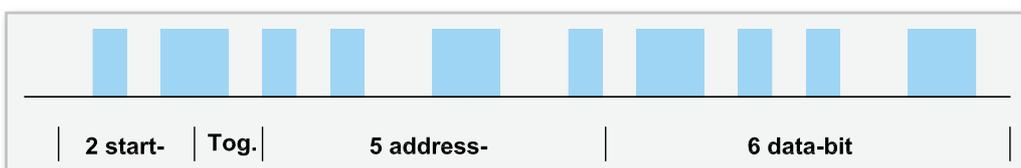
Bild 5: Aufbau des RC5-Fernbedienungsprotokolls
