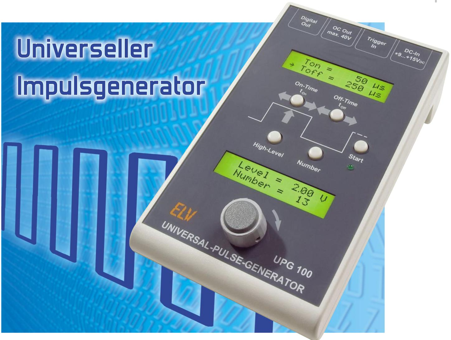
In der Messtechnik werden oft Signale mit bestimmten Puls- und Pausenzeiten benötigt. Der Impulsgenerator UPG 100 erlaubt durch den Einsatz eines Mikrocontrollers die separate Einstellung dieser Zeiten im Bereich von 10 µs bis 99,99999 s. Weiterhin ist es möglich, den Spannungspegel am Ausgang variabel einzustellen. Ein Open-Collector-Ausgang, ein externer Trigger-Eingang sowie die Möglichkeit zur Eingabe der Zyklenanzahl runden die Features dieses Gerätes ab.
