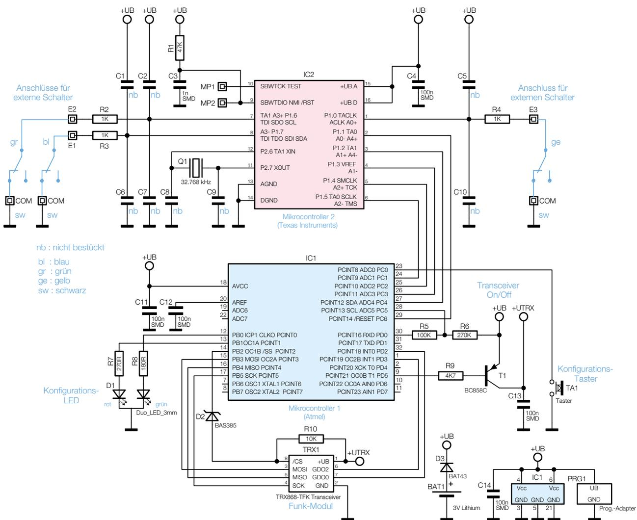
**Bild 2:** Schaltbild der Funk-Schalterschnittstelle HM-Swl-3-FM
