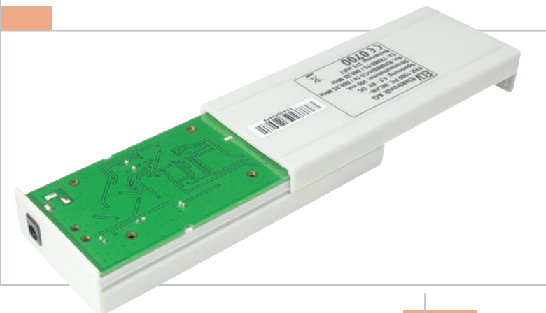
Komplett bestückte Leiterplatte des FHZ 1300 PC WLAN
