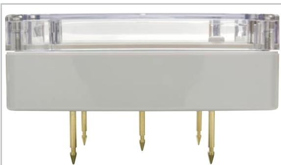
Bild 2: Die Anordnung der Messstifte. Der Stift für die Wassermeldung (Mitte) steht etwa 1,5 mm über der Messfläche.
