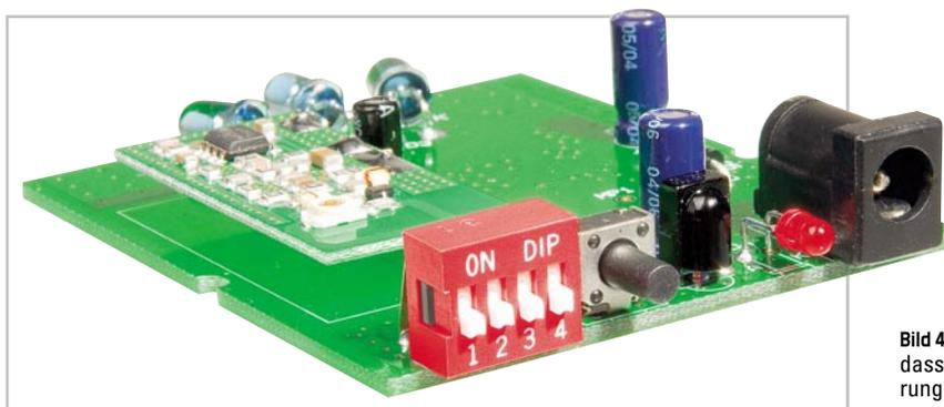
**Bild 4:** Die Einbaulage der LED. Sie ist so zu biegen, dass sie später genau in die vorgesehene Bohrung der Gehäuserückwand passt.
