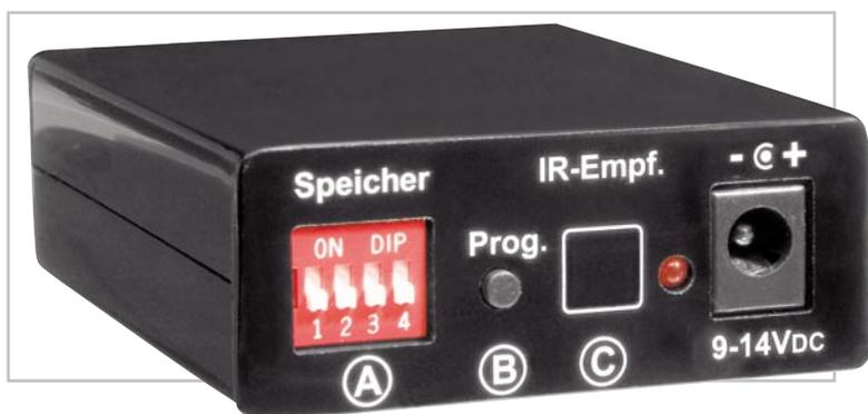
Bild 2: Ansicht der Geräterückseite mit Bedienelementen und A-, B-, C-Kennzeichnung für die Bedienreihenfolge
