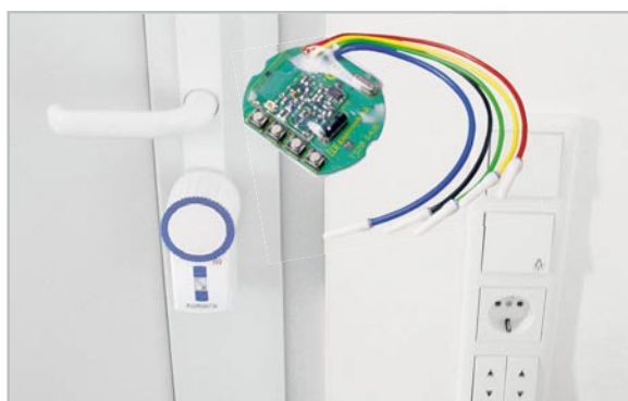
Bild 3: Rechts die dank Unterputz-Batteriesender sauber in die Installationsreihe eingepassten Tasten für die Öffnung der Garagentore, links der KeyMatic-Türschlossantrieb
