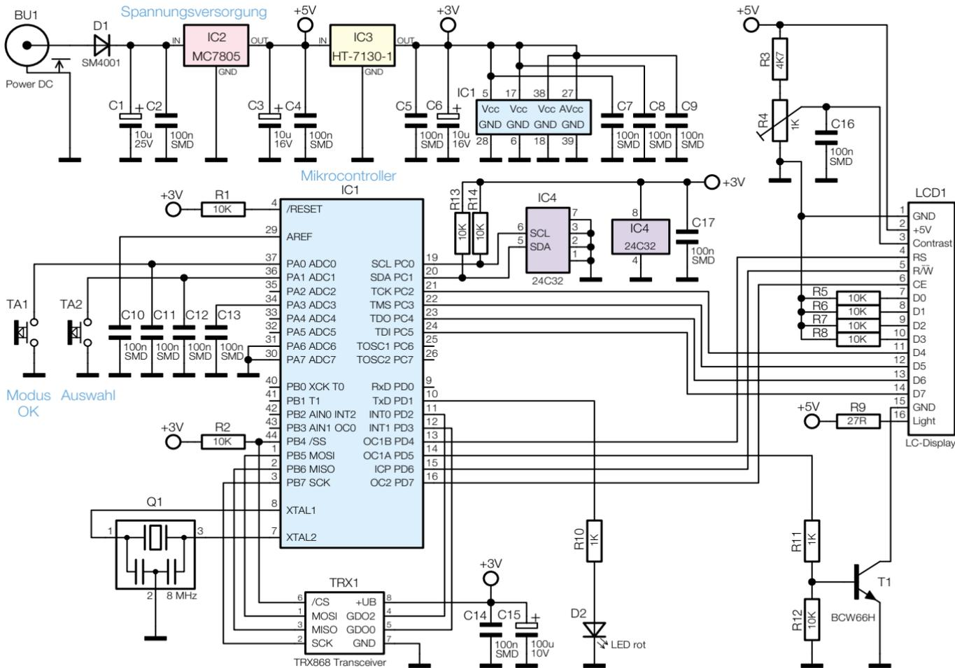
Bild 3: Das Schaltbild des Empfängers KFM 100 E
