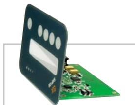
**Bild 7:** Aufgeklebte Frontplatte
