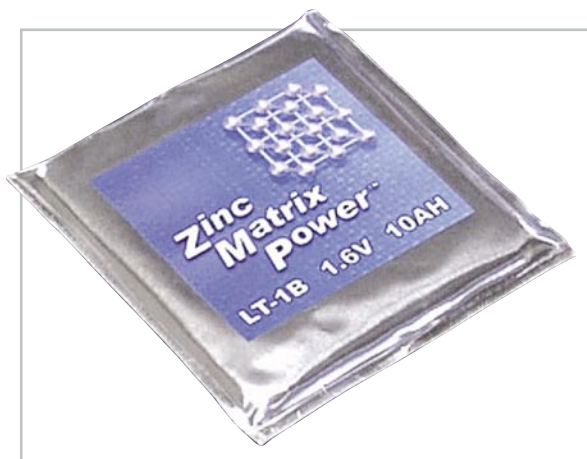
Bild 19: Labormuster eines Silber-Zink-Akkus
