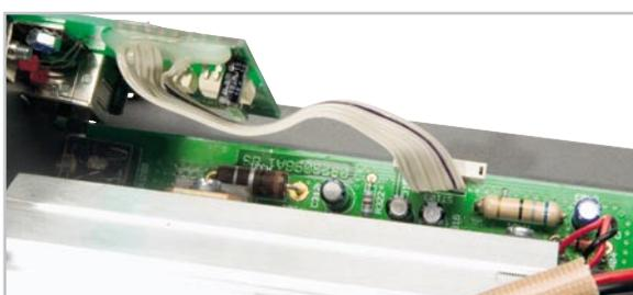
Bild 32: Anschluss der USB-Platine an die Basisplatte
