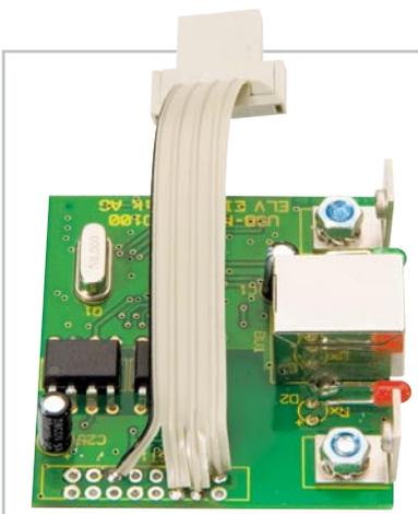
Bild 27: Anschluss des Flachbandkabels an die USB-Platine
