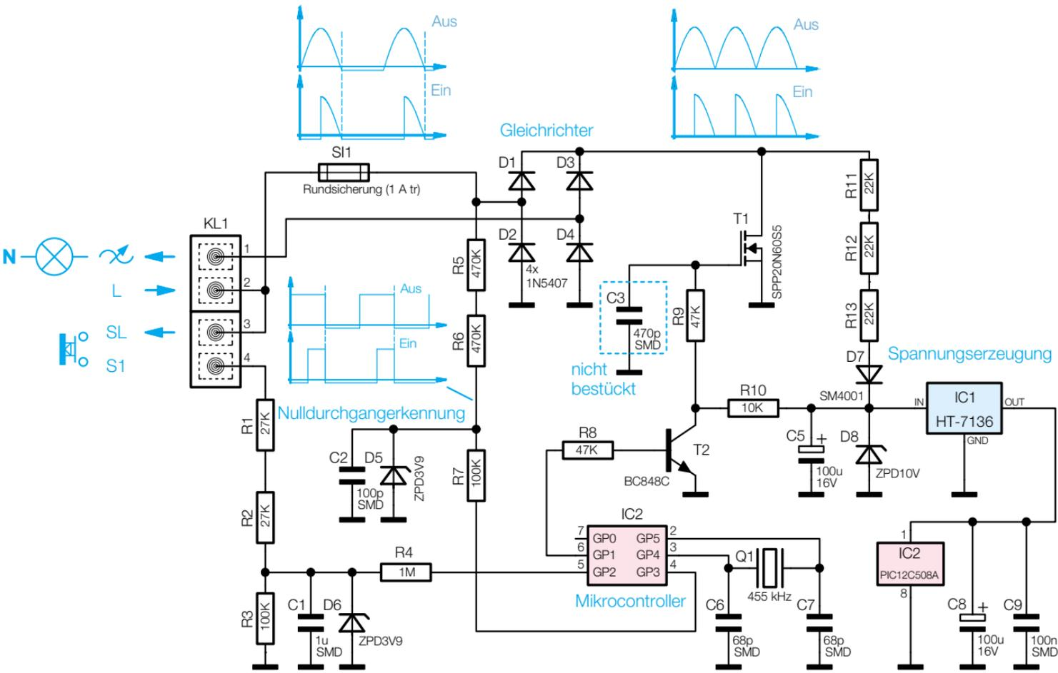
Bild 3: Die Schaltung des Phasenabschrittdimmers DI200 AB
