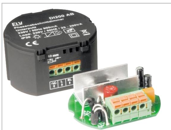
Bild 4: Der fertige Phasenabschnittdimmer DI200 AB
