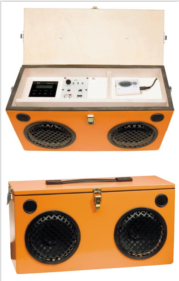
**Bild 12:** Die Box mit Klappdeckel. Hier erkennt man deutlich die zusätzliche Zwischenwand, die das Boxeninnere abschließt und das RDS-Radiomodul, die Klangregelbaugruppe sowie ein Fach für den Player trägt. Darunter dieselbe Box mit geschlossenem Deckel.
