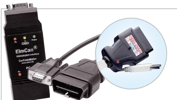
Bild 10: Stellen die Verbindung zwischen OBD-Schnittstelle und PC her: PC-Multinorm-Interfaces.
