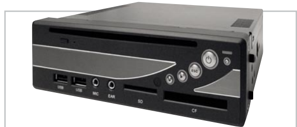
Bild 14: Passt sogar in einen Autoradioschacht – Car-PC mit CD-/DVD-Laufwerk, USB und Kartenleser
