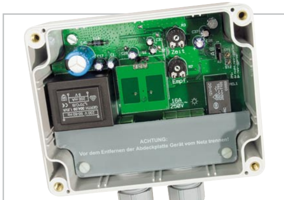
Bild 6: Über die Schraubklemmen wird die Abdeckplatte mit zwei Kunststoffschrauben montiert.
