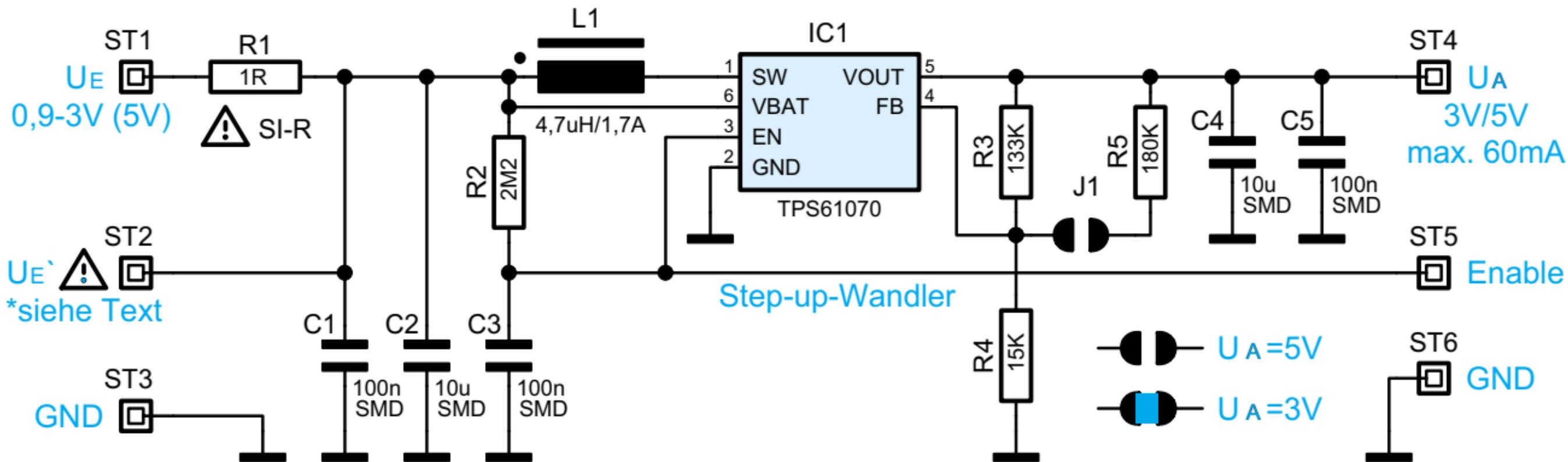
Bild 1: Schaltbild des Spannungswandlers
