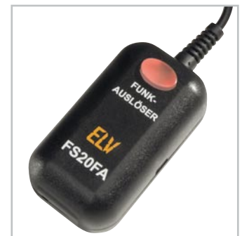
Bild 14: Die Tastkappe wird von zwei Leuchtdioden zum Aufleuchten gebracht.
