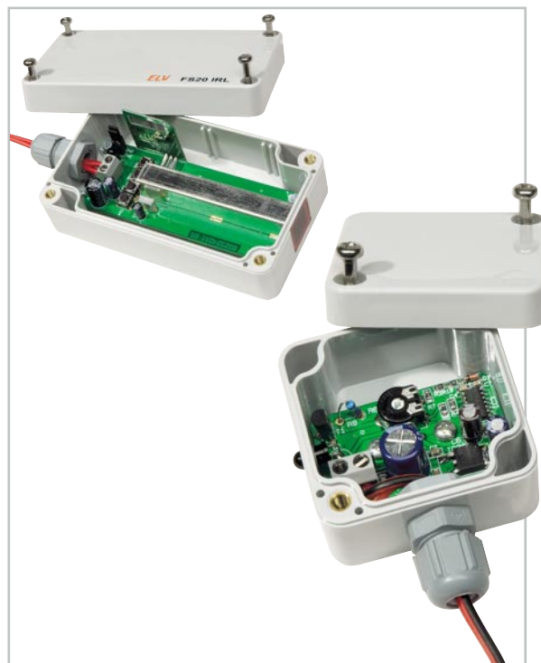
Bild 6: Die Gehäusedeckel mit umlaufender Neopren-Dichtung sind fest zu verschrauben.
