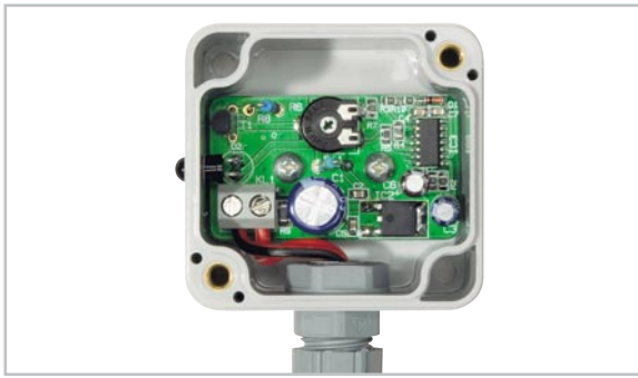
Bild 4: Im zugehörigen Gehäuse eingebaute IR-Sendeplatine
