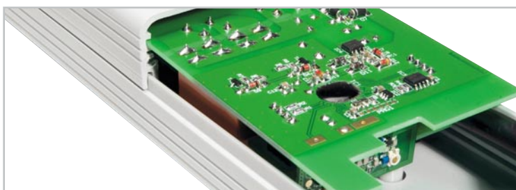
Bild 13: Die Elektronik-Platine wird in die in dieser Lage oberste Nut des Gehäuseunterteils eingesetzt.
