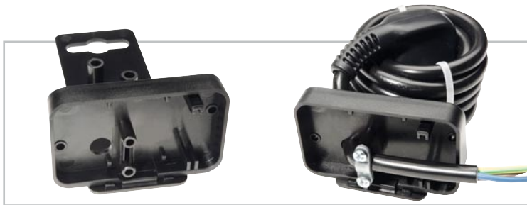
Bild 9: So erfolgt die Zugentlastung an der Endkappe, die äußere Isolierung ist auf 95 mm Länge entmantelt.
