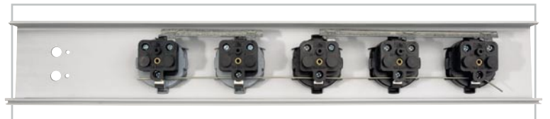
Bild 5: Der Schutzleiter-Verbinder und die Stromschienen für die jeweils rechten Kontakte sind eingesetzt und nach hinten in Richtung Steckdoseneinsatz gebogen.
