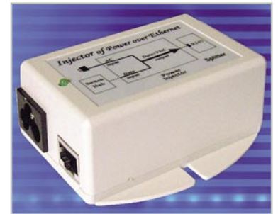
Bild 7: Wenn in einem Ethernet ohne PoE nur ein oder wenige PoE-Endgeräte betrieben werden sollen, ist ein Single-Power-Injector die billigste Lösung. (Foto: Laird Technologies)
