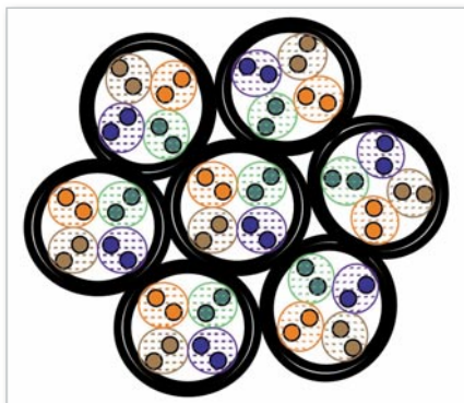
Bild 14: Bei gebündelten PoE-Kabeln erwärmen sich die innenliegenden naturgemäß am stärksten. (Quelle: Reichle &amp; De-Massari)
