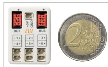
**Bild 1:** Größenvergleich des Lichtbus-Moduls mit einer Zwei-Euro-Münze
