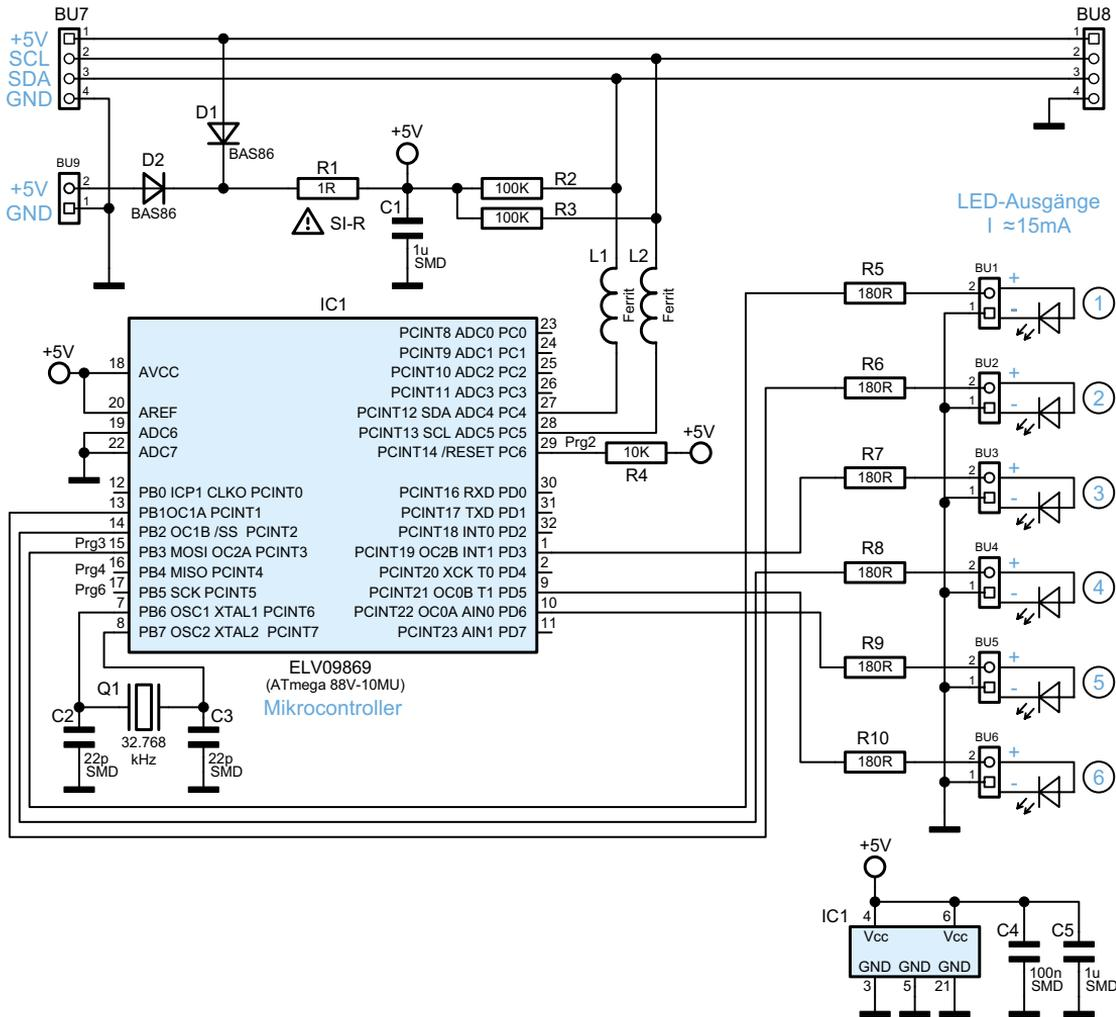
Bild 5: Das Schaltbild des Lichtbus-Moduls
