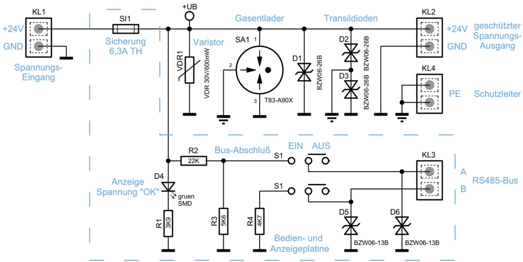
Bild 7: Die Schaltung des Überspannungsschutzgerätes.
