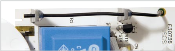
Bild 2: Fixierung der Antenne in den Antennenhaltern
