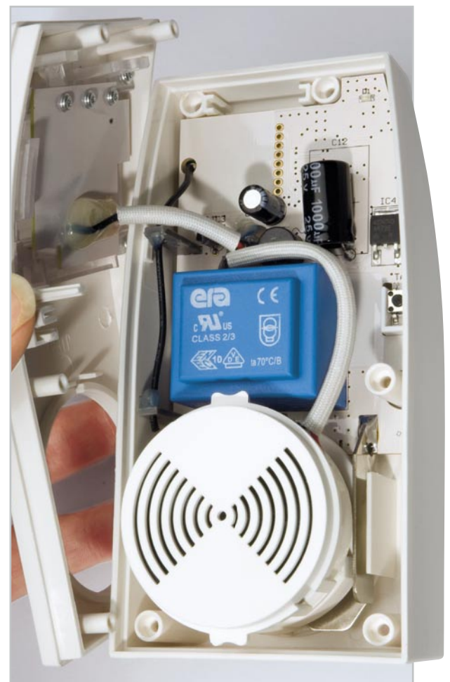
Bild 9: Die Lage aller Komponenten (inkl. Verlegung der Lautsprecherleitung) vor dem Zusammenbau des Gehäuses
