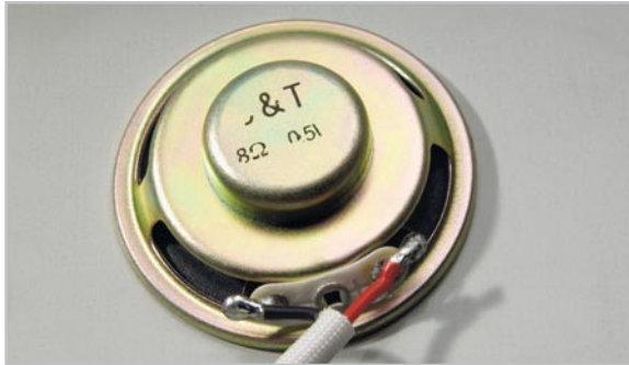
Bild 6: Montage der Lautsprecherleitungen am Lautsprecher
