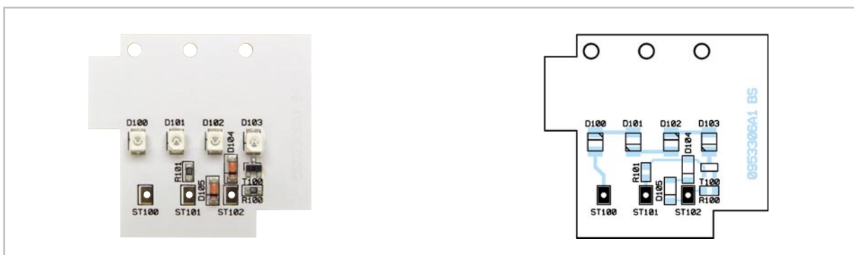
Ansicht der bestückten LED-Einheit mit zugehörigem Bestückungsplan
