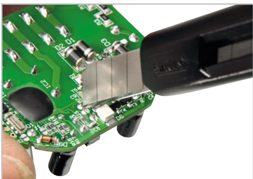
Bild 5: Durch Auftrennen einer kleinen Leiterbahn zwischen den Kontaktflächen einer Lötbrücke kann der „Toggle-Mode“ konfiguriert werden.
