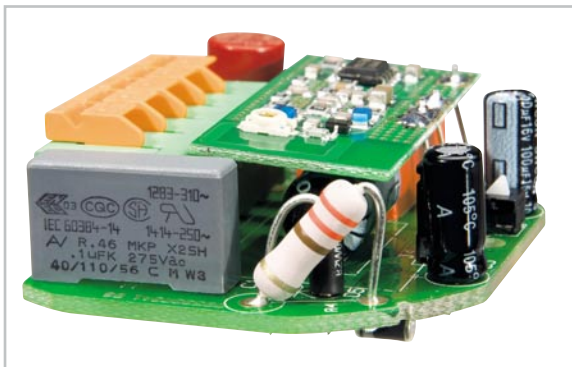
Bild 8: Einbau der Transildiode D 5 und des Widerstands R 4
