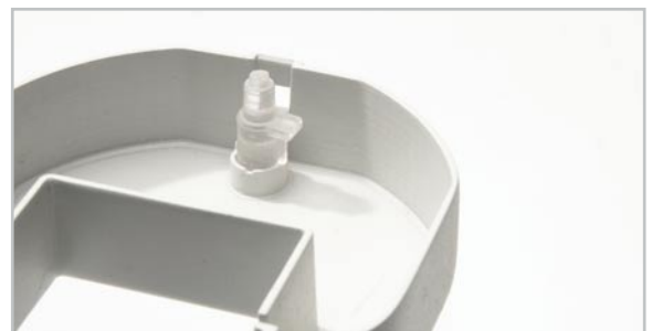
Bild 11: Einsetzen der transparenten Schaltachse in das Gehäuseoberteil
