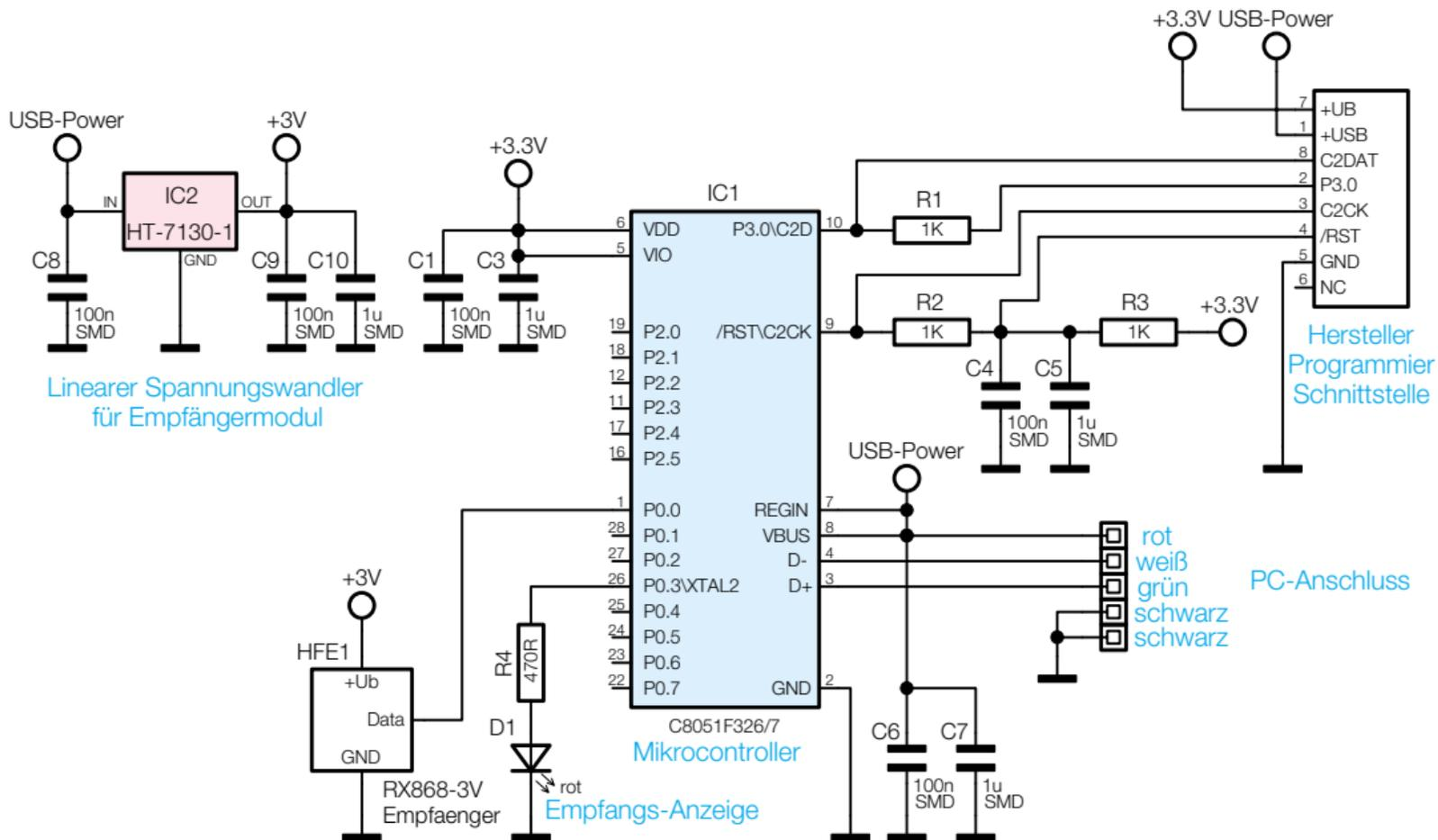
Linearer Spannungswandler für Empfängermodul
