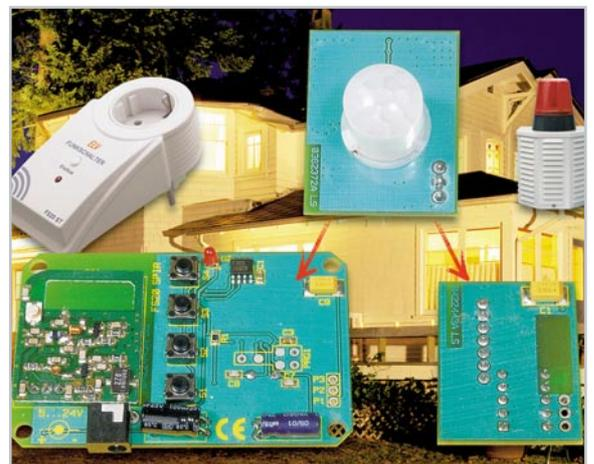
**Bild 3:** Einfach den PIR MR16 statt des PIR 13 anschließen – schon ist der neue Bewegungsmelder in das FS20-System eingebunden!
