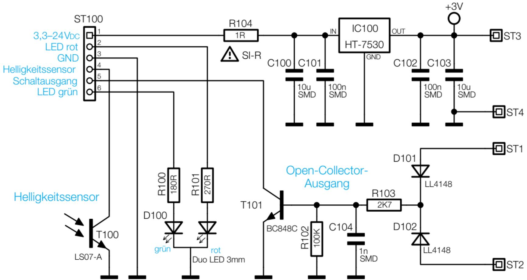
Bild 6: Die Schaltung der Anschlussplatine
