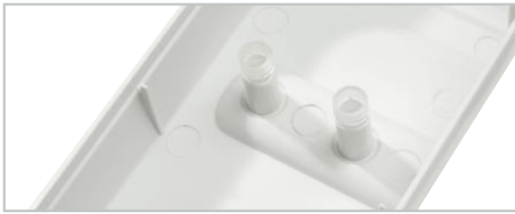
Bild 12: Für die LED-Anzeigen werden im Gehäuseoberteil 2 Kunststoff-Lichtleiter eingesetzt.
