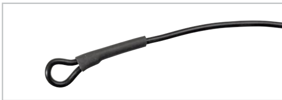
Bild 9: Das freie Ende der Wurfantenne ist in eine kleine Schlaufe zu legen und entsprechend der Abbildung zu verschumpfen.
