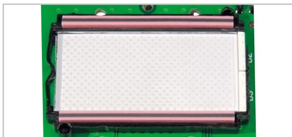
Bild 7: Einsetzen des Reflektor-Papiers und der Lichtverteilplatte
