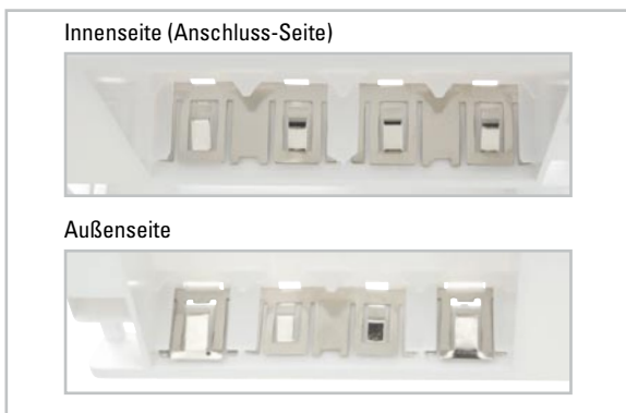
Bild 12: So werden die Batteriekontakte in das Batteriefach eingesetzt.
