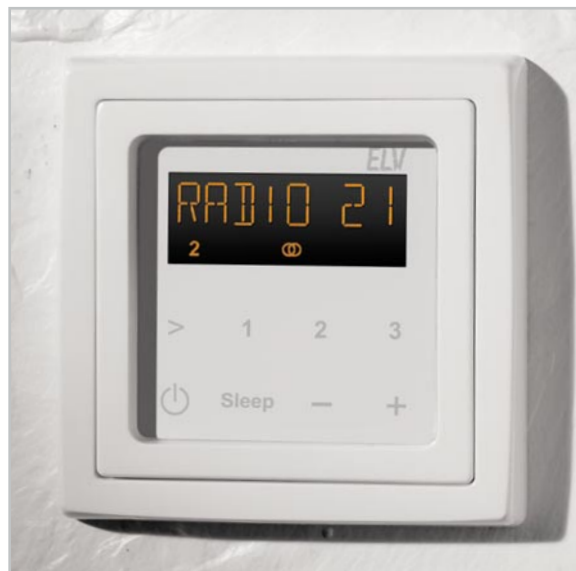
Bild 2: Das Radio in der Unterputz-Schalterdose
