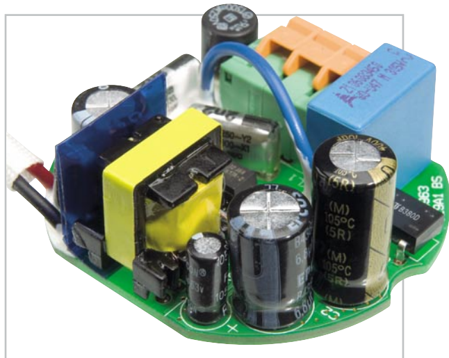
Bild 4: Platine mit bestücktem Leistungsübertrager
