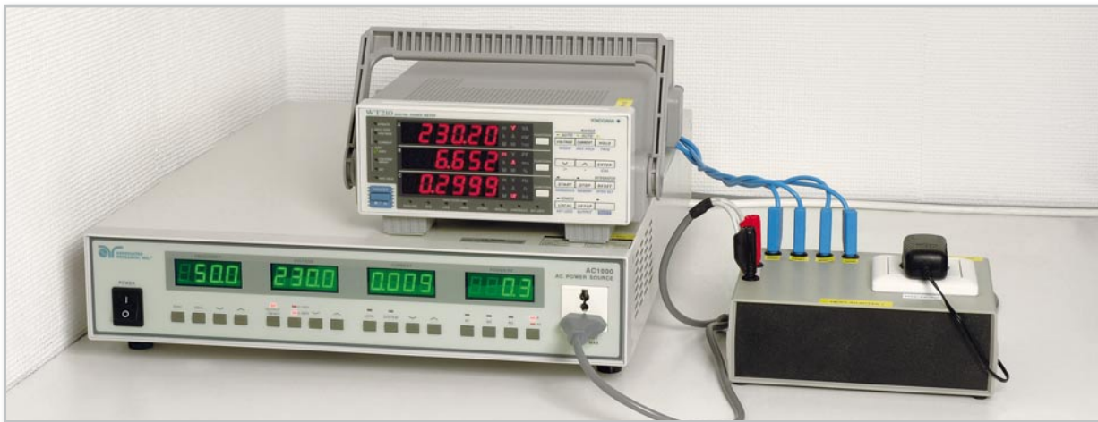
Bild 1: Prüfaufbau zur Messung des Stand-by-Verbrauchs
