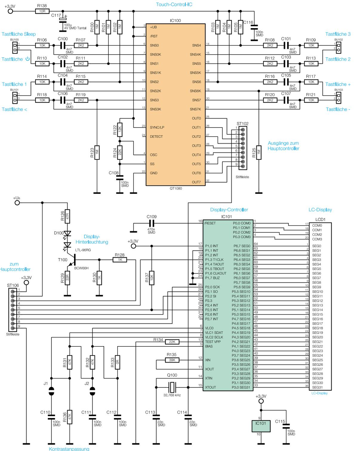
Bild B: Touchcontrol-Bedieneinheit des RDS100 UP und Display mit Displaycontroller
