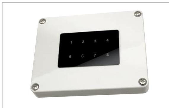
Bild 10: Frontplatte ohne Gehäusedurchbruch vor ein IP-65-Gehäuse geklebt
