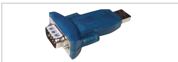
Bild 1: Für PC-Betrieb ideal, für eigene Applikationen nicht flexibel genug – ein handelsüblicher USB-zu-RS232-Adapter
