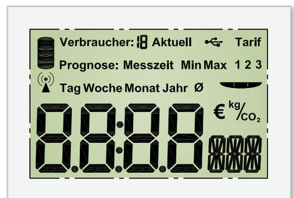
Bild 1: Alle zur Verfügung stehenden Segmente des EA-8000-Displays
