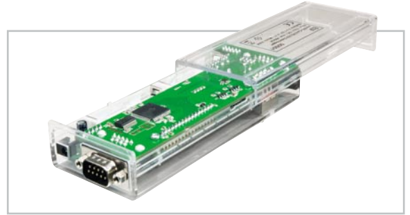
Bild 9: Erst nach dem Kürzen aller mehr als 1,5 mm abstehenden Kontakte sollte das Gehäuse durch Aufschieben des Unterteils geschlossen werden. Vorher können natürlich noch Batterien eingelegt werden.
