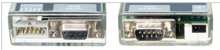
Bild 1: Hier sind die Schnittstellen des SDDS1 gezeigt. Von links nach rechts: 3-bis-5-V-TTL-Eingang, RS232-Buchse, RS232-Stecker, externe 5-bis-7-Vdc-Versorgung.
