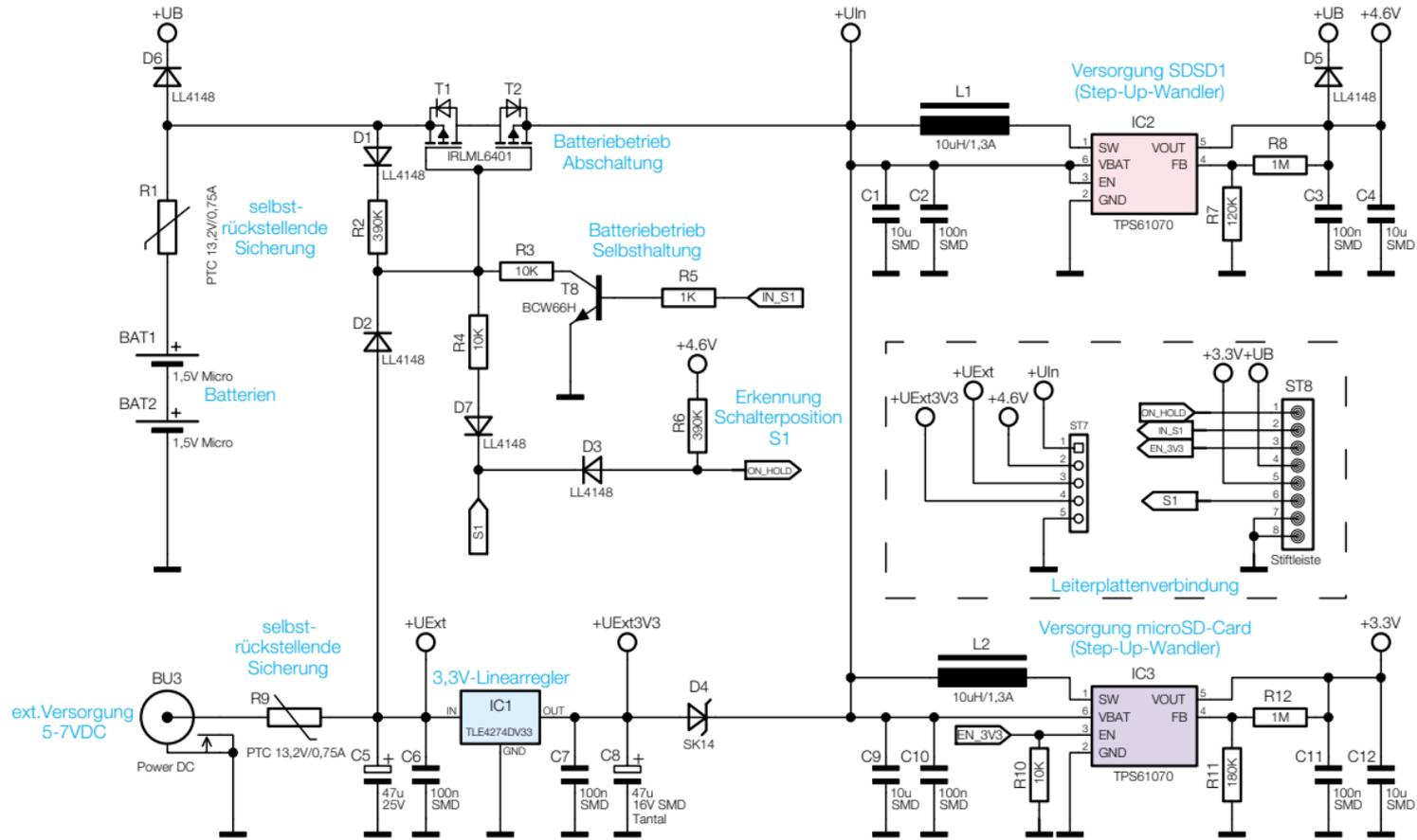
Bild 4: Das Schaltbild der Spannungsversorgung des SSSD1 enthält die Bauelemente der Batterieplatine.
