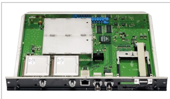
Bild 20: Mit einer derartigen Kassette lassen sich zwei Transponder eines Satelliten in IPTV-Datenströme umwandeln. (Quelle: GSS)
