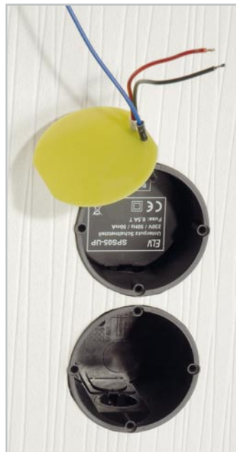
Bild 27: Das Unterputz-Netzteil SPS05-UP ist bei abgeschalteter Netzspannung anzuschließen und, wie abgebildet, in eine tiefe Schalterdose einzusetzen.
