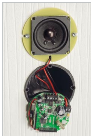
Bild 31: Anschluss des Lautsprechers und der Versorgungsspannung am Radiomodul
