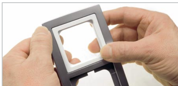
Bild 33: Der Adapterrahmen zur Aufnahme der Lautsprecher-Frontplatte wird in den Abdeckrahmen geklebt.
