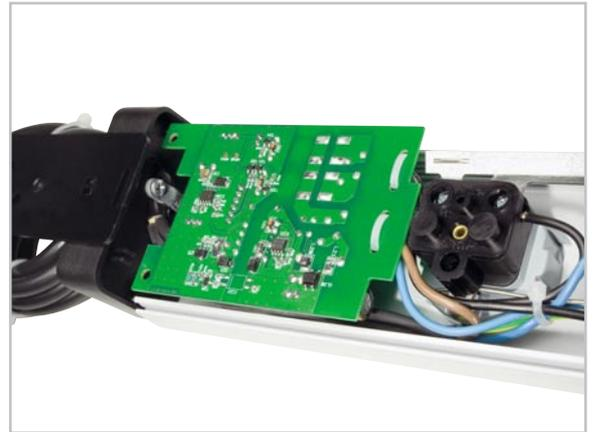
**Bild 28:** Das Einlegen der Platine erfolgt kopfüber.
