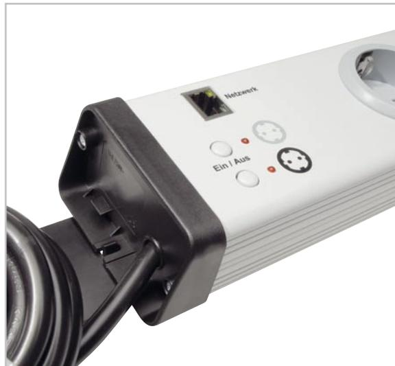
**Bild 32:** Nach abschließender Sichtkontrolle zum richtigen Sitz von Netzbuchse, Tastern und LEDs können die Endkappen aufgeschraubt werden.
