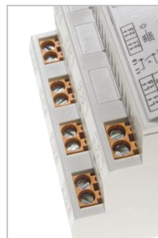
**Bild 8:** Nur bei exakter Lage der Elektronik-Einheit im Gehäuse lässt sich diese bis zum Anschlag einschieben, so dass die Schraubklemmen sauber in den zugeordneten Öffnungen sitzen.
