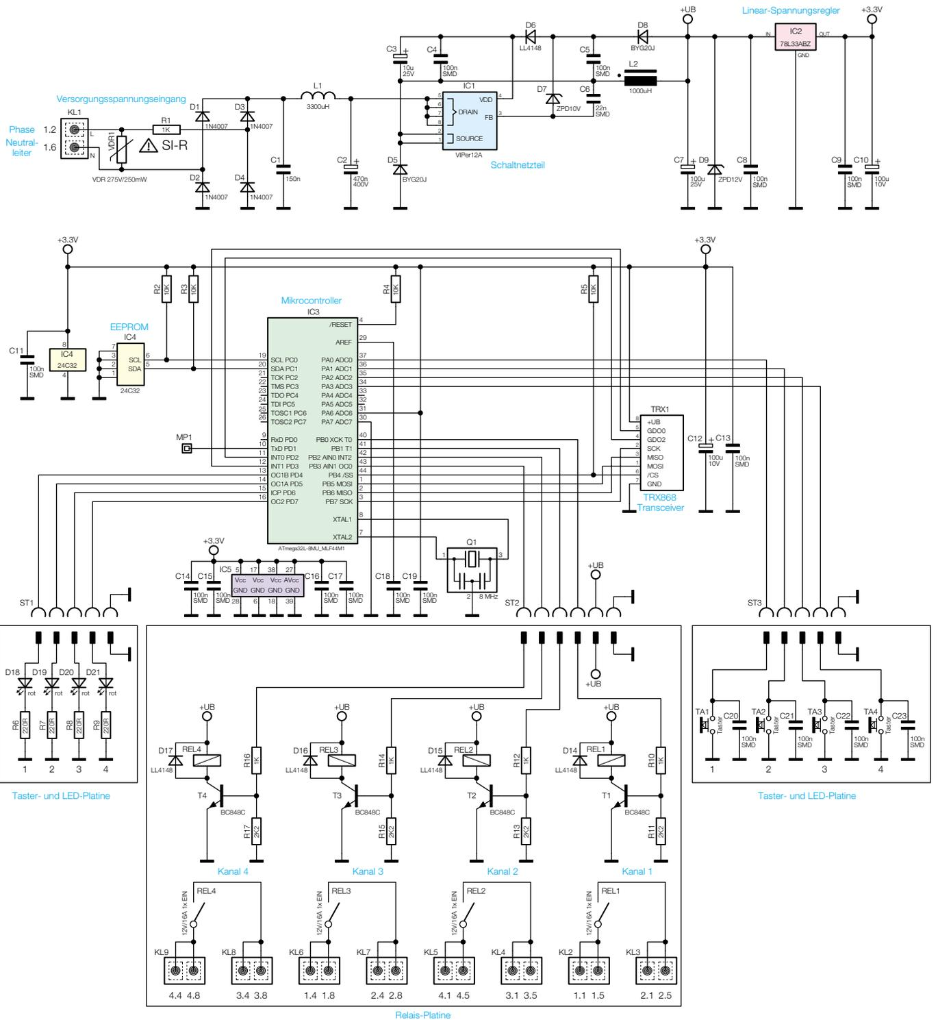
Bild 3: Schaltbild des 4-Kanal-Funkschalters
