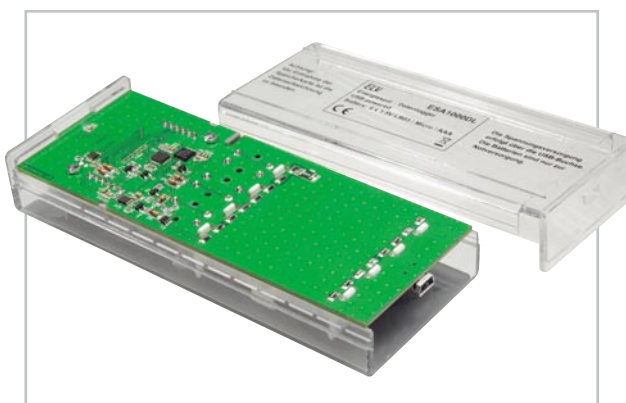
Bild 9: So erfolgt das Einsetzen in das Gehäuse: Platine kopfüber in das Oberteil einlegen, danach Unterteil aufschieben.
