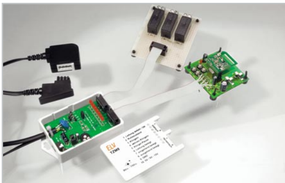
Bild 7: Applikationsbeispiel für die Anbindung des TZM8 an Relais als statische Aktoren und den 4-Kanal-FS20-Sendebaustein FS20 S4M
